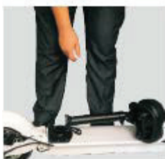
Etapa 6: Lăsați tubul cu șaua în jos, culcat pe scooter, țineți ușor apăsat în jos mânerul de pliere cu piciorul stâng.
