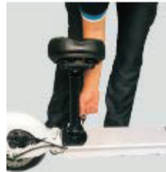
Etapa 4: Trageți către exterior mânerul de pliere.
