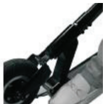
Etapa 2: Depliați tija cu ghidonul, stabiliți platforma cu piciorul stâng și ridicați tubul frontal cu ambele mâini.
