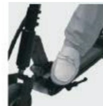
6. Pentru a bloca mecanismul de pliere, așezați scoter-ul pe sol, împingeți levierul în jos.
