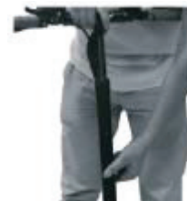
2. Apăsați pe butonul de pe tija frontală și culisați în jos bara în formă de T.
